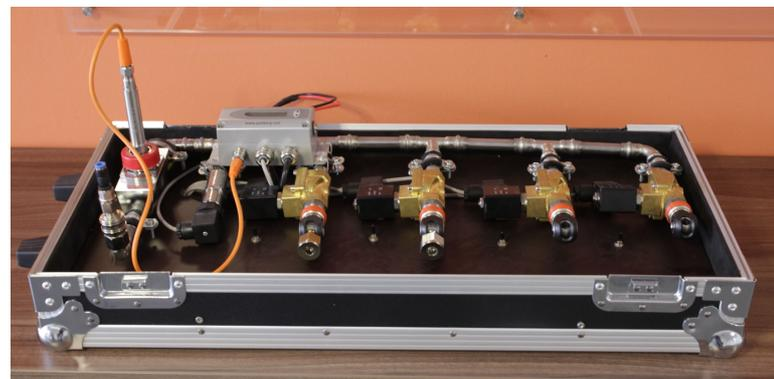
Druckluftkoffer mit Volumensensor und zuschaltbaren Leckagen
