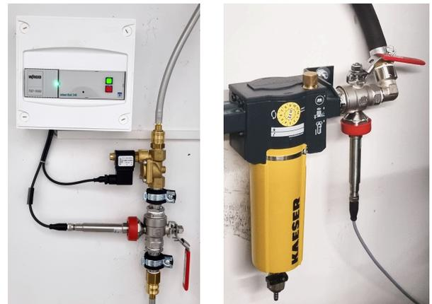
Auswerteeinheit und Volumenstromsensoren des Demonstrators
